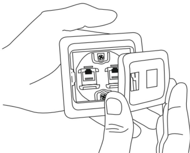
Отсоединить разъем розетки от корпуса отведением защелок разъемов на лицевой стороне, и вдавливания их во внутрь.
