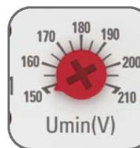
Регулировка минимального напряжения
