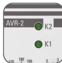
Индикация состояния контакторов
