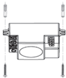
Рис.8. Монтаж датчика MW-706
