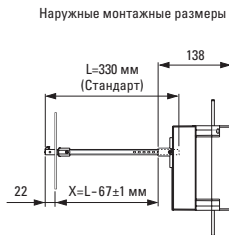
Рисунок 9г - Монтажные размеры при установке на дверцу шкафа для рубильников 400-630 А
