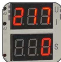
Отображение текущего напряжения, тока и мощности
