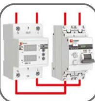
Подключение нагрузки до 14 кВА
