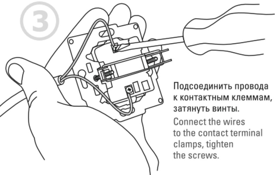
Подсоединить провода к контактным клеммам, затянуть винты.
