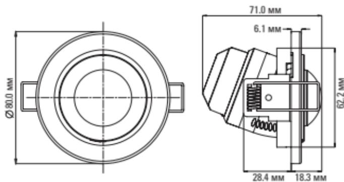
Рис. 3. Габаритные и установочные размеры датчика MS-300
