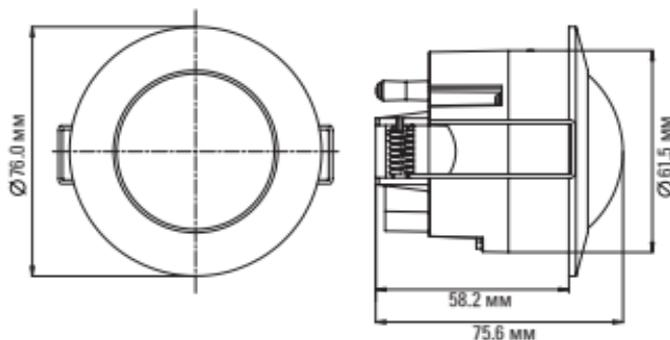
Рис. 1. Габаритные и установочные размеры датчика MS-100
