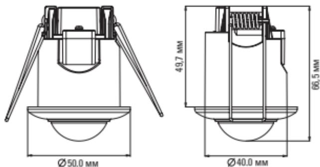
Рис. 2. Габаритные и установочные размеры датчика MS-200
