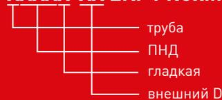
Трубы гладкие ПНД изготовлены из полиэтилена низкого давления и применяются для прокладки кабеля открытого или скрытого типа по полам и в стенах зданий, а также в грунте. За счет своей жесткости гладкие трубы ПНД служат хорошей защитой от механических повреждений и всевозможных воздействий окружающей среды.
