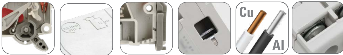
Автоматическая доводка рукоятки управления Момент затяжки и глубина зачистки провода на корпусе Углубления для удобного демонтажа с DIN-рейки. Можно снять одной отверткой Клеммы с насечками для надежного соединения с проводниками Возможна коммутация алюминиевым и медным проводом Отверстия для крепления U-образной шины типа FORK
